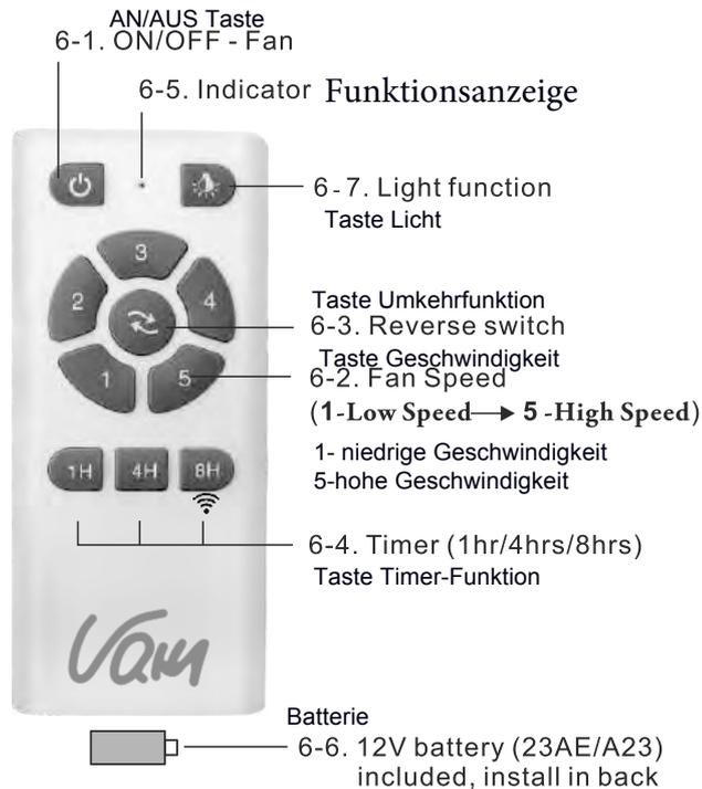
**Hinweis: Drücken Sie die AN/AUS Taste, um den Lüfter ein- und auszuschalten. Die Fernbedienung behält die letzten Einstellungen (Lüftergeschwindigkeit und Lichtdimmstufe) im Speicher. Das Ein- und Ausschalten des Lüfters über die Hauptstromversorgung führt zu der anfänglichen Einstellung (Lüfter aus und Licht an)**
